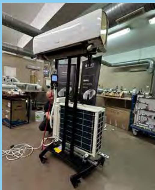
Szkolenie zakończyło się sprawdzeniem poprawności działania zbudowanego układu klimatyzacji
